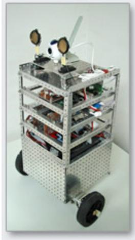
El robot Sancho3 es un prototipo destinado a realizar entre otras actividades, labores de vigilancia y supervisión de edificios. Para llevar a cabo esta actividad, Sancho3, incorpora una serie de sensores para percibir el entorno físico en el que se desenvuelve: sensores de ultrasonidos para la medida de distancias de manera similar al comportamiento de los murciélagos, y utilización de cámaras (una o dos) para la captura de imágenes.
